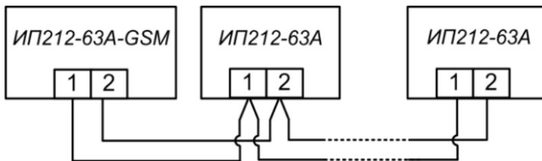
Рис.6 Схема соединения извещателей в группу
