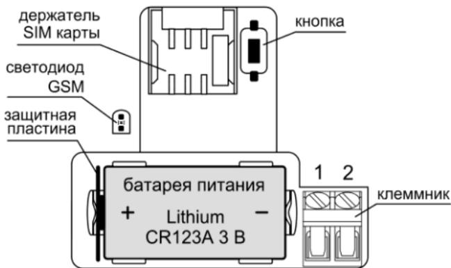
Рис.2 Батарейный отсек. Светодиод «GSM»
